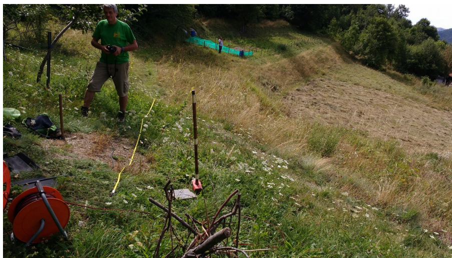
Foto 2 – Esecuzione prospezione sismica a rifrazione e masw S2
